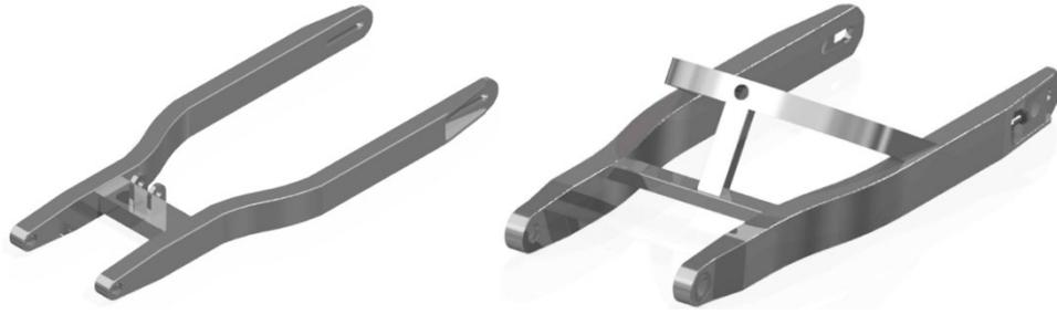
Ilustración 8: Desviaciones de diseño del basculante inicial al del prototipo.
